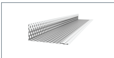
7. Cembrit ventilační profil, vyrobeno z perforovaného ocelového plechu tl. 0.6 mm, délka 3000 mm. Minimální šířka větrané mezery v případě použití mřížky je 40 mm
