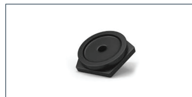
Nýtovací nástavec Pro Aku kleště: závit M 10 x 1 pro nýt 4 nebo 4,8 mm. Pro ruční kleště: závit M 8 x 1 pro nýt 4 nebo 4,8 mm.
