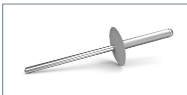
Cembrit trhací nýty pro hliníkovou podkladní konstrukci 4,0 (14) x 20 (svěť nýtu 14). Nýty mají hliníkové tělo a hlavu z nerezové oceli. Jsou dodávány jak nebarvené, tak v barvách fasádních desek.
