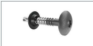
Cembrit vruty do oceli se středící podložkou SCR-S 4.8x29 mm materiál: nerez A2 (v barvě desky) (pro desky Cembrit Cover, Cembrit Solid a Cembrit Transparent)
