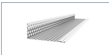
10. Cembrit ventilační profil , vyrobeno z perforovaného ocelového plechu tl. 0.6 mm, délka 3000 mm. Minimální šířka větrané mezery v případě použití mřížky je 40 mm.
