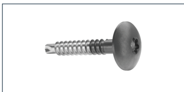
Cembrit vruty do oceli bez středící podložky SCR-S 4.8x29mm materiál: nerez A2 (v barvě desky) (pro desky Cembrit Patina design line a Cembrit Raw)
